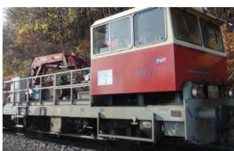
Pour la même raison, des draisines (engins techniques permettant de dégager les obstacles), ont circulé sur les axes Saint-Germain - Saint-Martin et Aurillac-Bretenoux.
