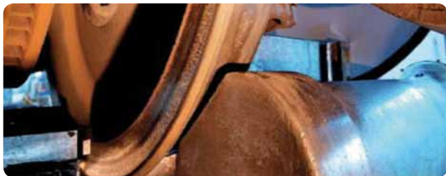
Réusinage d'une roue en atelier pour supprimer le méplat
